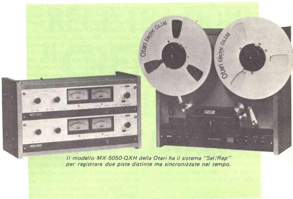
*Il modello MX-5050-QXH della Otari ha il sistema "Sel/Rep" per registrare due piste distinte ma sincronizzate nel tempo.*
